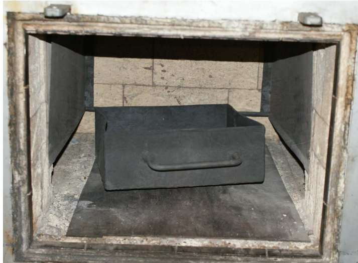
Kuva 3. Uunin sisusta ja peltinen laatikko testikappaleille.
